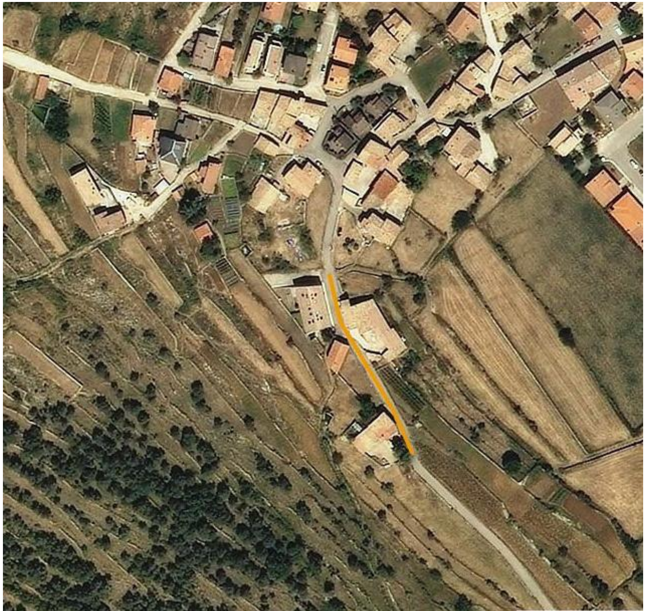
Planta General del nou tram de prolongació del clavegueram residual i pluvial al camí de la piscina.
